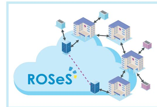
ROSeS propose la mise en place de **boucles optiques dédiées** entre établissements grâce à des **fibres noires**, idéal pour les **applicatifs sensibles** ou à **fort volume de données**.
